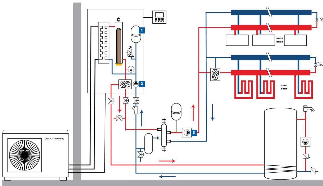
NOTE: 1. Vaso d'espansione riferito al circuito d'impianto. Verificare che quanto incluso nell'unità sia sufficiente allo scopo. 2. Circolatore primario lato impianto. 3. Circolatore secondario lato impianto.
