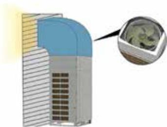
Il design del ventilatore dell'unità esterna consente una pressione statica dell'unità esterna molto elevata, con un range da 0 a 110 Pa. Questo rende l'installazione della macchina più versatile e adatta alle diverse tipologie di ambiente,
