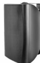
Diffusore acustico due vie da parete (speaker da 6.5" tweeter da 1.5"). Montaggio superficiale mediante la staffa metallica di fissaggio inclusa, orientabile, contenitore plastico in ABS resistente alla fiamma, griglia metallica per la protezione della parte a vista. Supporta linee a 70 V o 100 V, tramite selettore può essere impostato per erogare una potenza di 5 / 10 / 20 / 40 W.
