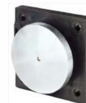
Le contropiastre della serie S02, SH2, S00 utilizzano un disco in acciaio montato su un apposito ammortizzatore in grado di assorbire parte dell'impatto causato dalla porta in apertura. L'elasticità dell'ammortizzatore consente inoltre un perfetto accoppiamento del disco al magnete.
