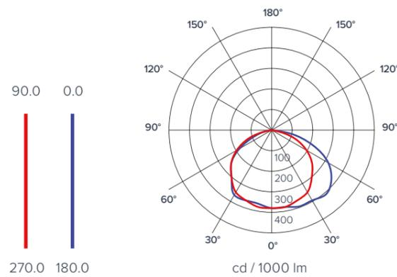
Diagramma fotometrico 18W e 24W
