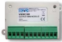
I moduli della serie Argus permettono di supervisionare lo stato di dispositivi esterni (moduli di ingresso) o di controllare dispositivi o attuatori esterni (Moduli di uscita). I moduli includono un isolatore di corto circuito e sono disponibili nella versione Mini (96 x 52mm) o da parete (86 x 86 mm)
