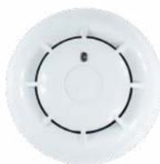
Basato sull'effetto Tyndall (diffusione della luce) il rivelatore ID100 è in grado di dare una risposta rapida ed efficace al primo insorgere di un focolaio d'incendio, in grado di rilevare una vasta gamma di particelle generate dalla combustione. Il design della camera, la sigillatura della parte superiore del rivelatore, la rete con maglie da 500 micron contro l'ingresso degli insetti garantiscono una eccezionale reiezione ai falsi allarmi.
