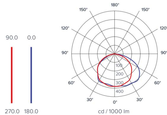
Diagramma fotometrico 18W e 24W
