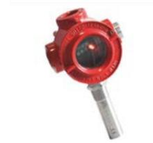
Rivelatore di temperatura ad assorbimento (per centrali convenzionali) serie TMP2-JO e TMP2-TO, custodia antideflagrante certificata ATEX. Reset automatico. Certificazione ATEX II 2G Ex d IIC T6
