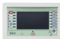
Unità di controllo principale per le funzionalità voice EVAC. Va inserito nel pannello frontale e si collega alla barra CANDRIVE+ se alloggiato nell'asola superiore, oppure al modulo FPM alloggiato nell'asola superiore se alloggiato nell'asola inferiore. È dotata di display grafico a colori con touchscreen. Si occupa della gestione e coordinamento dei vari moduli funzione a lei assegnati. Una singola centrale Previdia UltraVox può alloggiare una sola di queste unità.
