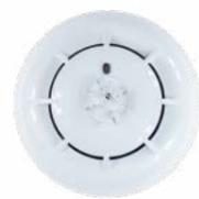
Il rivelatore può essere impostato nelle modalità: A1R (soglia fissa a 58°C e rivelazione termovelocimetrica), B (Soglia fissa a 72°C), A2S (Soglia fissa a 58°C), BR (soglia fissa a 72°C con rivelazione termovelocimetrica). Grazie alla sua alta versatilità si adatta a tutte quelle condizioni dove la rivelazione del fumo risulta difficile e suscettibile di falsi allarmi.
