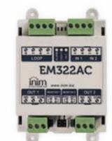
Si collega al Loop e dispone di due ingressi supervisionati (in grado di controllare lo stato di un dispositivo esterno) e di due relè in grado di pilotare carichi a tensione di rete 230 V AC. Per ciascuno dei due relè di uscita è possibile attivare la funzione di supervisione che permette di controllare se, in condizioni di relè a riposo, ci sia tensione ai capi del contatto.
