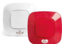
Segnalatore ottico/acustico funzionante da 20 a 30 V DC, grado di protezione IP65. Tramite DIP SWITCH è possibile selezionare il tono di allarme scegliendo tra i 14 disponibili, regolare volume e potenza del lampeggiatore.
