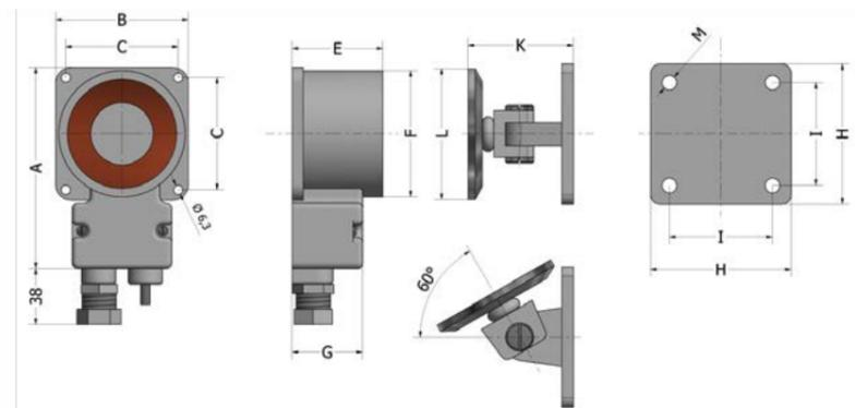
Fermi elettromagnetici per ambienti con elevato rischio esplosione, forza di tenuta nominale garantita utilizzando la contropiastre snodata GH (fornita), gli elettromagneti sono certificati in accordo con la classe di protezione II T6 II2G ml EX1, 2 (gas, nebbia,vapore). EX II2 D TDA21 IP65 T80 °C, per l'impiego in zona 21, 22 (polveri). Forza di tenuta 65, 130 o 200 Kg a seconda del modello, connessione tramite cavo standard (1 m già incluso).
