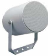
Diffusore acustico tipo proiettore. Montaggio mediante la staffa metallica di fissaggio inclusa, orientabile, contenitore plastico in ABS resistente alla fiamma, griglia metallica per la protezione della parte a vista. Supporta linee a 70 V o 100 V, tramite selettore può essere impostato per erogare una potenza di 5 / 10 / 20 W.
