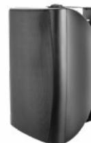
Diffusore acustico due vie da parete (speaker da 4", tweeter da 1"). Montaggio superficiale mediante la staffa metallica di fissaggio inclusa, orientabile, contenitore plastico in ABS resistente alla fiamma, griglia metallica per la protezione della parte a vista. Supporta linee a 70 V o 100 V, tramite selettore può essere impostato per erogare una potenza di 2.5 / 5 / 10 o 20 W.
