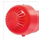
I segnalatori di allarme Intrinsically Safe di seguito riportati sono certificati per l'uso in ambienti classificati ATEX per il gruppo I (miniera) e il gruppo II (superficie). Questi segnalatori vanno utilizzati in combinazione con una barriera Zener o galvanica certificata. Le caratteristiche della barriera non devono superare Uo: 28 V, Io: 93 mA, Po: 660 mW, Ci: 0, Li 0. Il valore minimo di Uo non dovrebbe scendere sotto i 23.6 V e il valore minimo di Io dovrebbe non scendere sotto i 50 mA.
