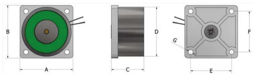
Fermi elettromagnetici per applicazioni dove non è richiesto pulsante di sblocco e protezione IP. I fermi della serie S1, alimentati a 24 V, sono disponibili nei diversi modelli con varie forze di tenuta (50, 100, 150 Kg). Connessione su fili liberi o su morsetti, forniti con contropiastra snodata per aperture ad anta o con contropiastra fissa per portoni scorrevoli, in materiale plastico o in acciaio.
