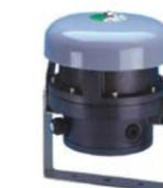
La campana Explosion Proof è progettata per l'uso nelle aree classificate come Zona 1 e 2. Grado di protezione IP66, certificato ATEX II 2G Exd e IIC T6. Con un'uscita audio fino a 105 dB, fornisce un segnale chiaro che risalta sul rumore di fondo.
