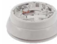
Occupi un proprio indirizzo per poter essere gestita in maniera indipendente dal rivelatore al quale è abbinata. Gestisce 32 toni differenti selezionabili da dip switch e può essere attivata con due differenti toni (attivazione di preallarme ed allarme). La base sirena è compatibile con i traslatori Indirizzati EWT100 o le espansioni XWT100. Il segnalatore può essere utilizzato come segnalatore autonomo da soffitto (senza rivelatore) tramite il tappo opzionale bianco o rosso.
