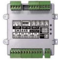
Il modulo si collega al Loop e mette a disposizione diversi ingressi e uscite a seconda del modello (vedi tabella). Nelle versioni equipaggiate con 4 ingressi 2 di questi possono essere configurati come zone convenzionali o ingressi 4-20 mA, alimentate dal Loop o da una fonte di alimentazione locale. Le 4 uscite sono, a seconda del modello, supervisionate per la gestione di segnalatori ottico acustici o dei contatti puliti.
