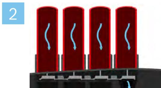
L'aria entra nell'unità e viene indirizzata ai rilevatori a camera di dispersione.
