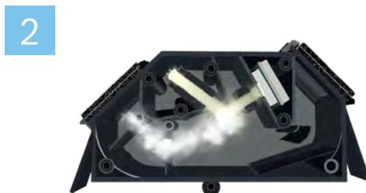
2 L'aria entra nell'unità e viene diretta ai moduli rilevatori a camera di dispersione per l'analisi ottica delle particelle visibili.
