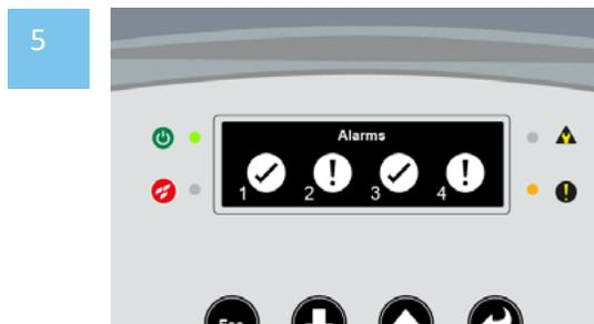
Una condizione di allarme viene attivata quando le particelle di fumo superano le soglie impostate.
