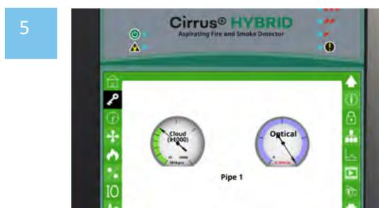
5 L'intelligenza artificiale del sistema analizza i segnali provenienti sia dai sensori ottici sia dal CCD, attivando l'allarme solo in presenza di condizioni reali di incendio.
