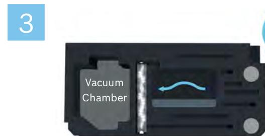
3 Contemporaneamente, l'aria viene aspirata nella camera a nuvola umida, dove l'umidità condensa sulle particelle di incendio formando una nuvola.
