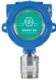
I rilevatori di gas serie **SMART3G-C2-LD** vengono impiegati per rivelare, in aree classificate, la presenza di sostanze infiammabili (% LFL), di gas tossici in ppm, gas refrigeranti oppure per la rivelazione di deficienza o eccesso di ossigeno.
