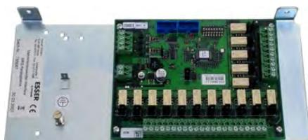
Il modulo fornisce 16 uscite relè a contatto pulito e può essere collegato alle centrali rivelazione incendio serie IQ8 (indice G o superiore). Collegabile alla centrale mediante cavo piatto.
