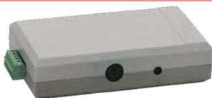
Interfaccia per la programmazione delle centrali incendio serie 8007, 8000 C/M, 8008, Gateway, centrale di spegnimento 8010 oppure per il collegamento diretto di una linea loop. Con l'alimentatore opzionale (cod. BME2Z002), i dispositivi di allarme alimentati da loop possono essere testati mediante il collegamento diretto all'interfaccia di programmazione PLUS. A tale fine è necessario il software di programmazione 8000 dalla versione V1.12.
