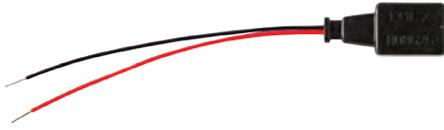
Il modulo di fine linea per moduli di ingresso viene utilizzato per il monitoraggio degli ingressi dei moduli esserbus® codici 808623, 808622. Il diodo zener necessario al corretto funzionamento è saldato direttamente sul modulo di fine linea.
