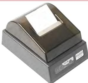
Stampante a modulo continuo per centrale di rivelazione incendio FlexES Control. L'alimentazione viene fornita da un alimentatore esterno. La stampante può essere montata come stampante da tavolo o a parete utilizzando la staffa in dotazione. Il collegamento avviene tramite l'interfaccia TTY della centrale FlexES Control.
