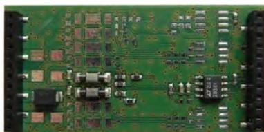
Modulo di interfaccia con protocollo RS422 o RS 485 a 4 fili per il collegamento di dispositivi remoti con protocollo RS422 o RS 485. Necessario per connettere un singolo pannello di segnalazione allarme GMT4000 (cod. FX808363 e FX808364). Modulo dotato di isolamento galvanico integrato.
