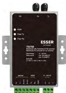
Dispositivo di interfaccia per collegare le centrali rivelazione incendio in rete fibra ottica. Per ogni centrale sono necessari almeno un modulo essernet ed un convertitore fibra ottica. Il convertitore deve essere installato all'interno della centrale rivelazione incendio oppure negli alloggiamenti ove possibile. Montaggio diretto su guida rail.
