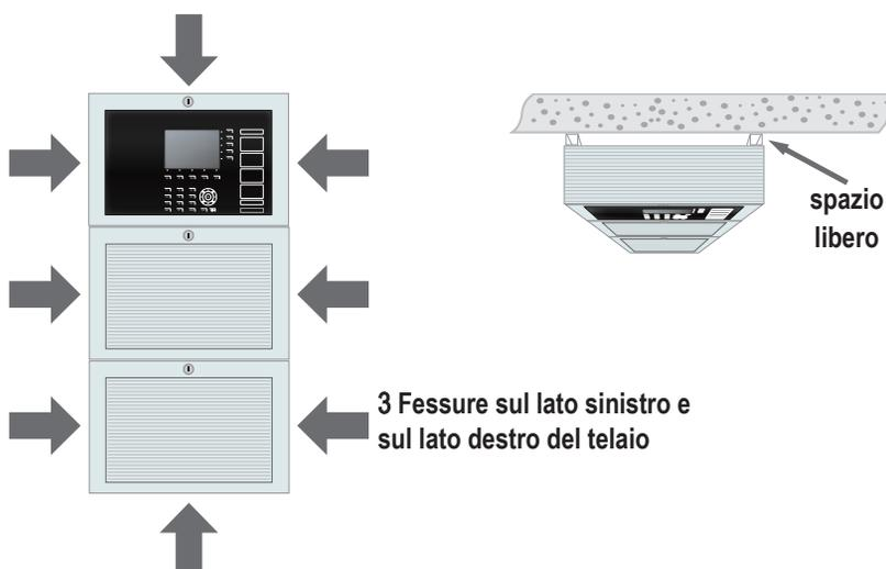
3 Fessure sul lato sinistro e sul lato destro del telaio
