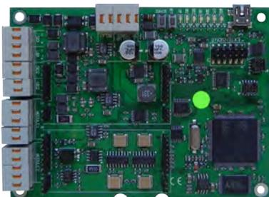
Scheda di interfaccia per la connessione ad anello alle centrali serie IQ8Control e FlexES Control delle interfacce utente e pannelli di segnalazione allarme. Monitoraggio dell'alimentazione e della linea di segnale in accordo alla EN54-13. Dispone di porta USB per manutenzione e risoluzione di problemi.
