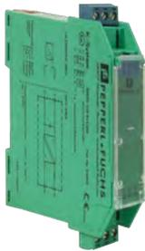
Barriera a sicurezza intrinseca per dispositivi IQ8Quad Ex (i) – Logica indirizzata
