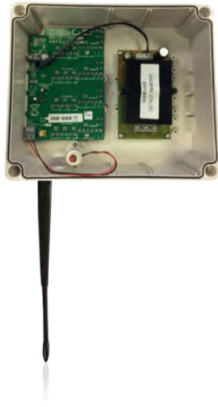
Il ripetitore D-TECT X è indicato per estendere la portata RF di un rilevatore D-TECT X o per amplificare il segnale in zone con scarsa ricezione.
