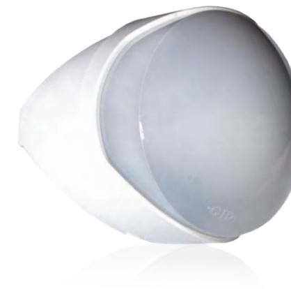
Il sensore di movimento PIR da esterno MX35 è un rilevatore particolarmente affidabile, a bassa tensione e a infrarossi passivi, indicato per applicazioni di allarme con sistemi di attivazione e attività di videosorveglianza.
