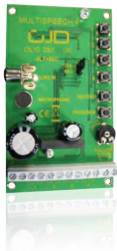
Multispeech è un modulo di segnalazione vocale a quattro canali indicato per il monitoraggio antintrusione, il controllo degli accessi, l'accoglienza, le comunicazioni e gli avvertimenti in generale. Su ciascuno dei quattro canali è possibile registrare un altro messaggio di 30 secondi o, in alternativa, un solo messaggio di 120 secondi.
