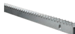
AJ91112/3 4 mt di cremagliera in acciaio trafilato C40, M4 (30x12) zincata e forata (oltre 600 Kg), completa di 12 perni distanziali
